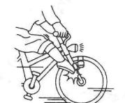
ダイナモの手元起動装置のない自転車のだいなも及びバッテリーランプの起動は必ず停車し、手で操作してください。
